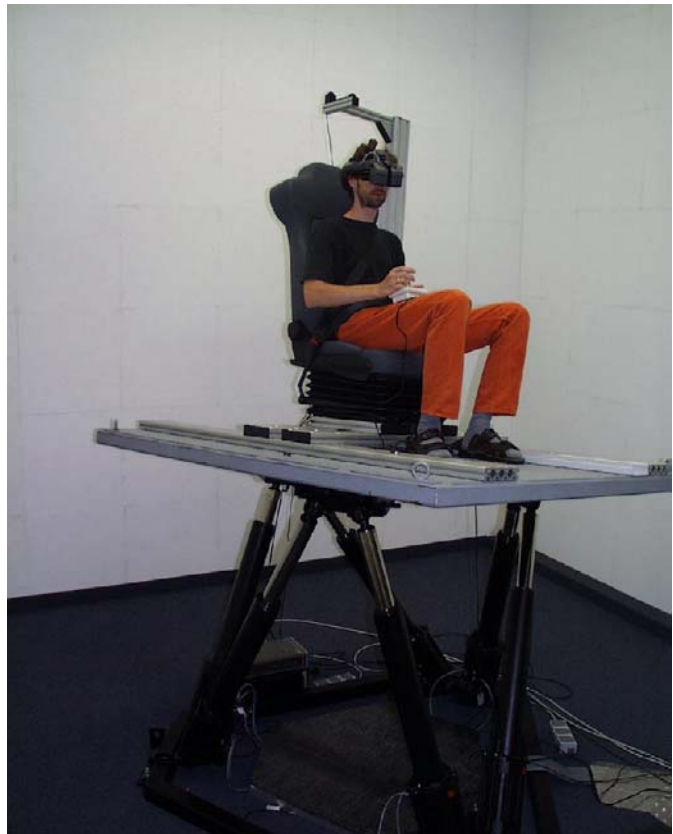
Abb. 3: Versuchsperson auf der Bewegungsplattform: Die Wahrnehmung der Eigenbewegung und das Sehen werden entkoppelt und getrennt voneinander manipuliert. So erhält man Rückschlüsse darauf, wie die Welt im Kopf repräsentiert wird.
