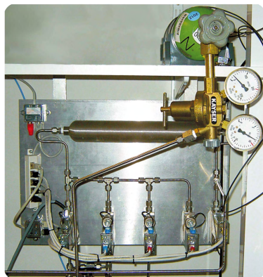
(a) Foto der Gasmischanlage
