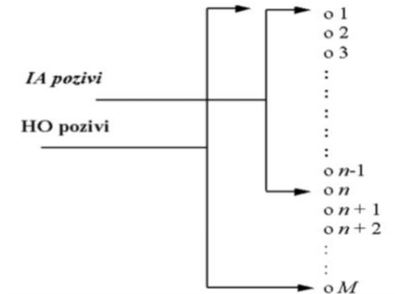
Slika 12. Prikaz višedimenzionalnog prometnog modela ćelije, [4]
