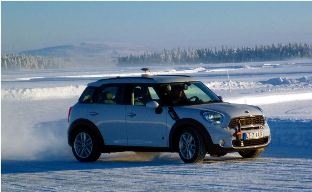
Abbildung 3.17: Versuchsträger FAIR während der Wintertestfahrten auf Niedrigreißwert
