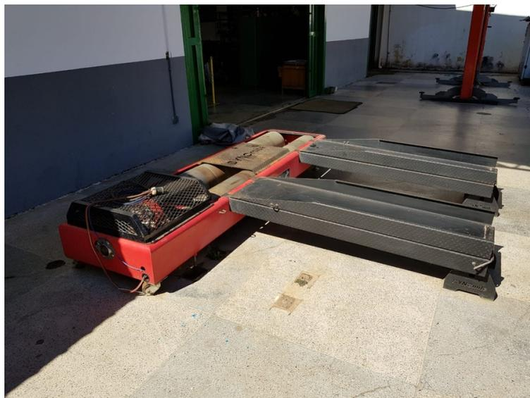
**Figura 28 – Dinamometro de rolo Dynamite**
