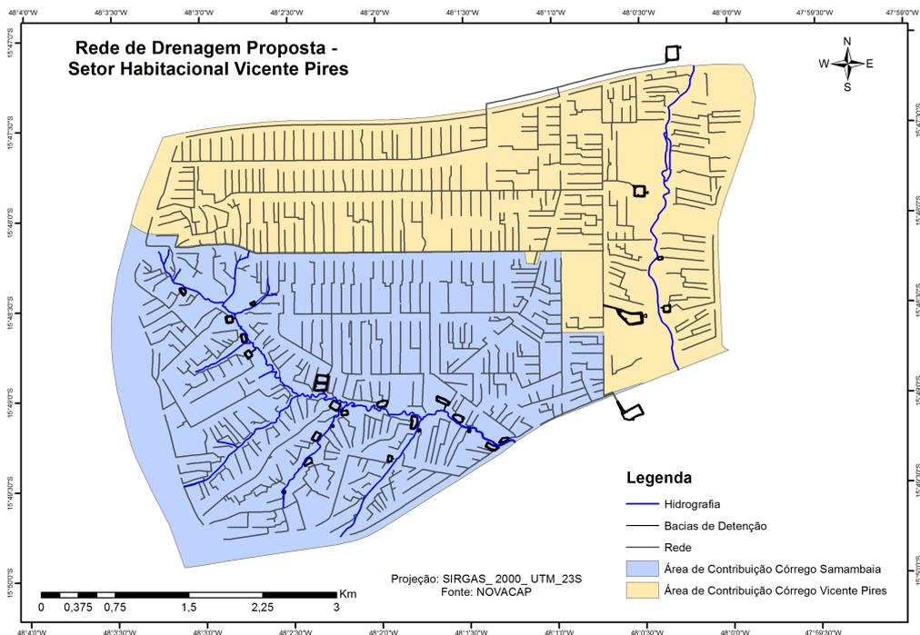
Figura 5.14 – Sistema de drenagem de águas pluviais proposto para o SHVP.
