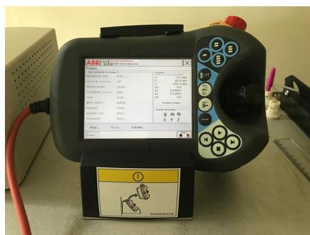
Figura 4.4: FlexPendant usado para movimentar o robô.
