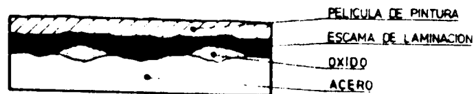
PELICULA APLICADA SOBRE ESCAMA DE LAMINACION Y OXIDO
