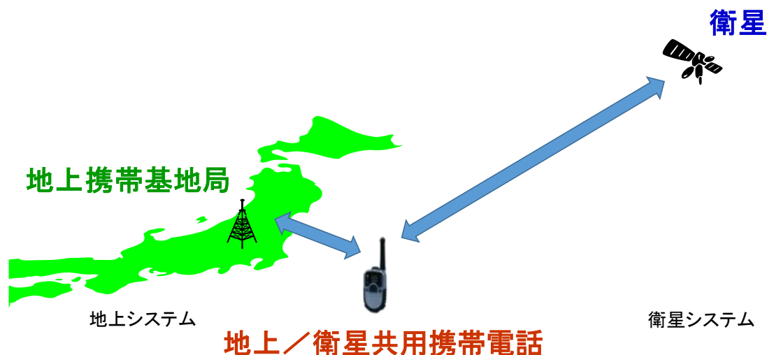
図 1.1-1 STICS 地上/衛星共用携帯電話システム
