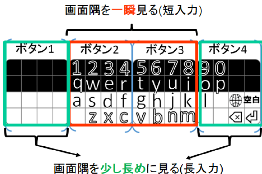
図 4.14 入力の長短に対応するボタン配置 Fig. 4.14. Button layout corresponding to input length
