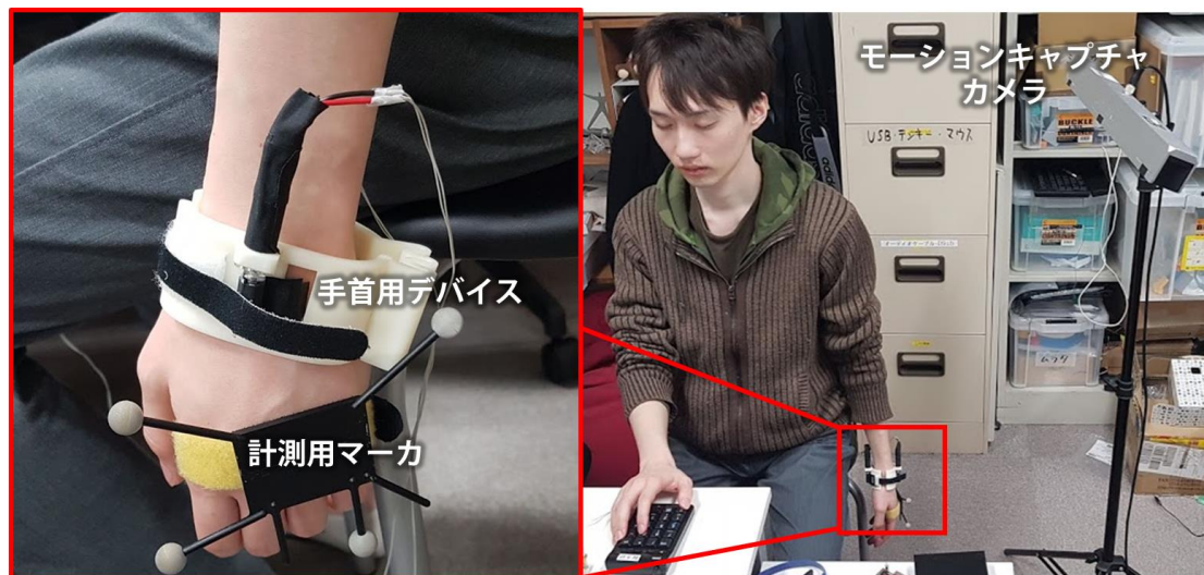
図 6.19 実験セットアップ。(左)手首デバイス及び計測用マーカ、(右)実験の様子とモーションキャプチャカメラの配置
