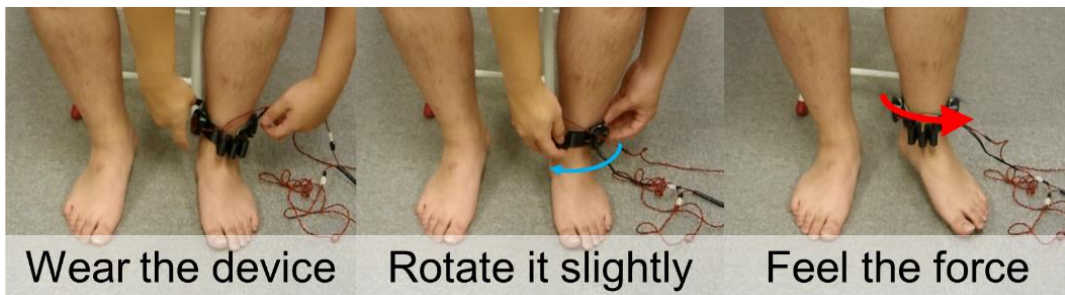
図 4.18 デバイスを用いたハンガー反射の誘発方法
