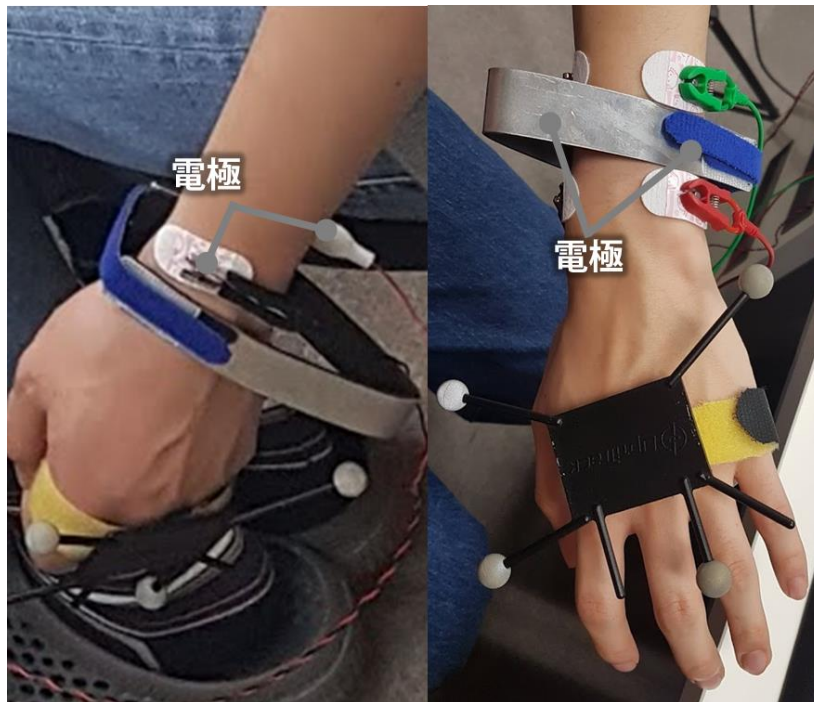
図 5.5 電気刺激の電極配置例. (左)深い電気刺激の電極配置, (右)浅い電気刺激の電極配置
