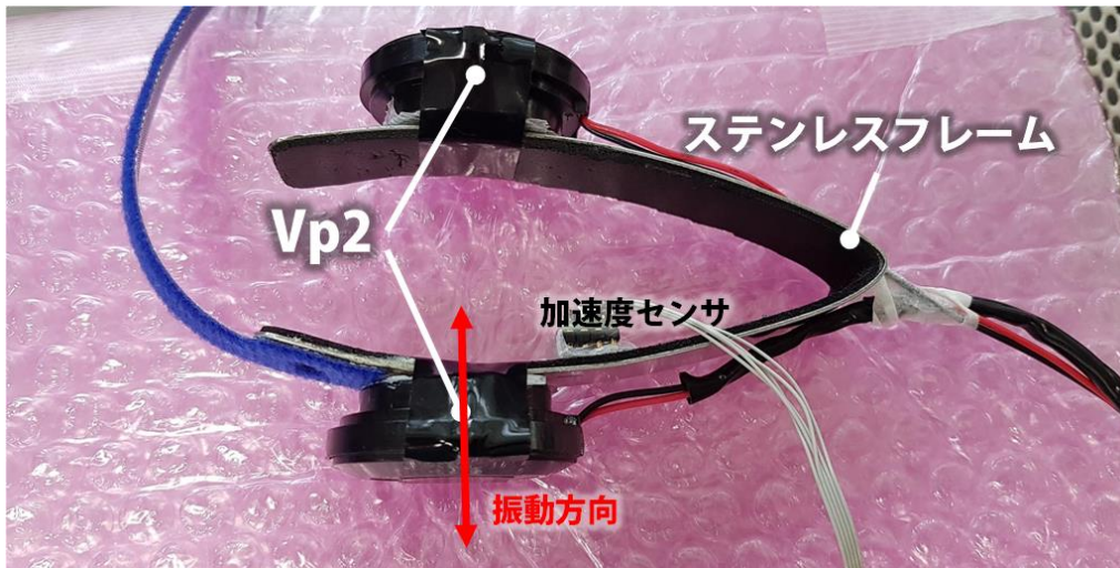
図 8.1 手首デバイス：クッション材の上で加速度センサを用いて加速度計測
