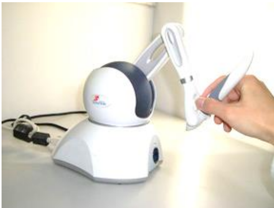
図 2.4 PHANToM[19]：ペン型のデバイスを介して力覚を提示する
