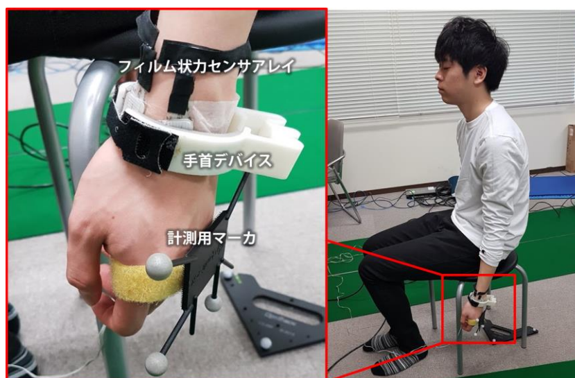
図 6.10 実験セットアップ。(左)デバイス装着の様子、(右)実験の様子
