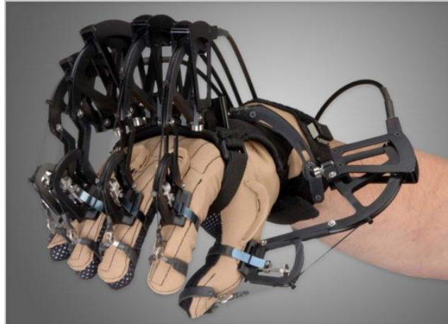
図 2.6 CyberGrasp[26]：手に外骨格デバイスを装着し物を把持した際の抵抗感を提示する
