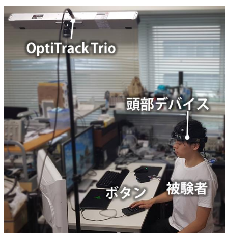
図 4.2 実験セットアップ：OptiTrackTrio を用いて頭部角度を計測し，テンキーのボタンによって被験者自ら試行を開始させた。
