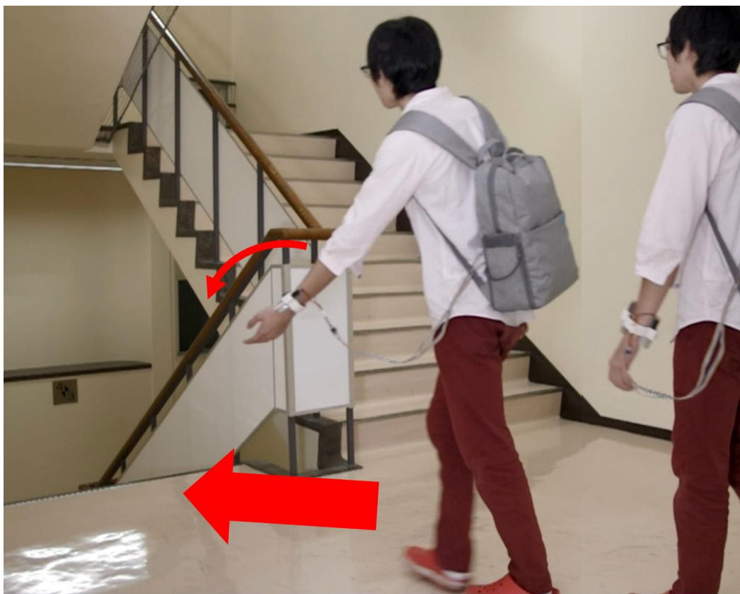
図 9.4 力覚提示を用いた直感的な方向提示：デバイスはベルト巻取りにより回転力覚を提示しユーザに進行方向を提示可能である
