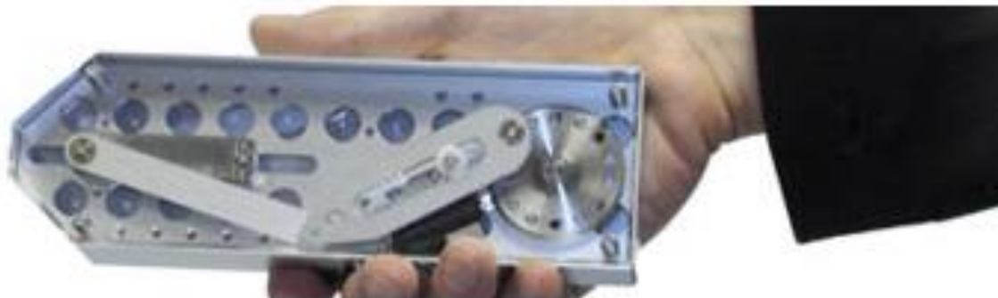
図 2.7 ぶるなび[15]：クランク機構により偏加速度を提示し牽引力を提示する
