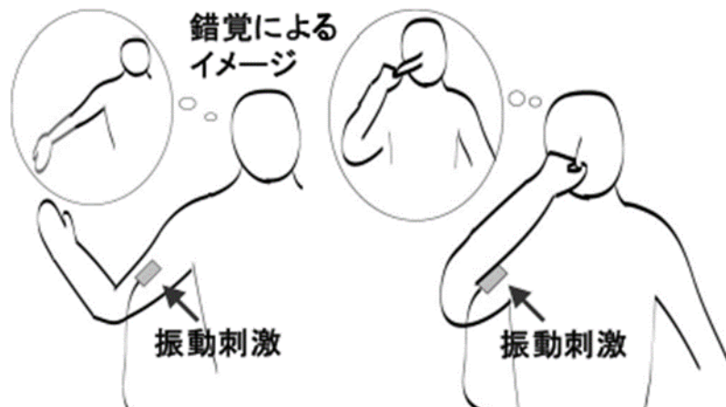
図 5.2 腱への振動刺激提示による運動錯覚([41]より引用)
