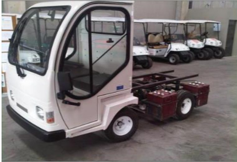
Figura 59. Furgón eléctrico modular. Nota: Camión de carga para transportar mercancía de forma más eficiente y eficaz. Fuente: City Model, 2015.
