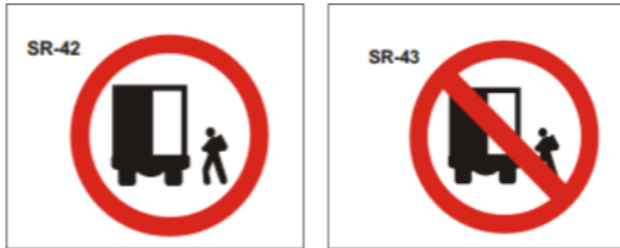
Figura 19. Señales Reglamentarias para Zonas de Carga y Descarga para Vehículos de Carga. Fuente: Fondo de Prevención Vial, 2004.
