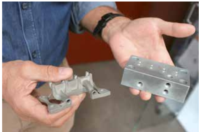
Schlagwort: Gewichtsreduktion um 90 bis 95 %. rechts konventionell, links additiv gefertigter Hydraulik-Block
