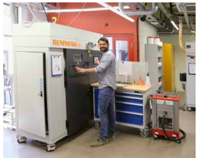
Patrik Hochreutener, Wissenschaftlicher Assistent, an einer der beiden im Einsatz befindlichen Drucker zum Selektiven Laserschmelzen (SLM) Renishaw AM400 HT (400 W Laser, 499°C Bauraumheizung), Renishaw AM250 (200 W Laser), Arbeitsraum: 250×250×320 mm, Schichtauflösung: 30 - 50µm Werkstoffe: Edelstahl 1.4404 (316L); Werkzeugstahl 1.2709; Ti6Al4V; AlSi10Mg, weitere Materialien auf Anfrage.
