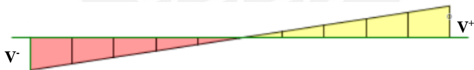
Figura 38. Fuerzas cortantes en una viga (Propia)
