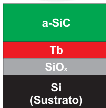
Figura 4.1: Estructura bicapa de SiC y Tb depositadas sobre sustrato de silicio oxidado térmicamente.
