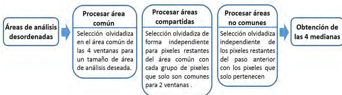
Figura 3.7 Diagrama de ejecución para procesar 4 píxeles.
