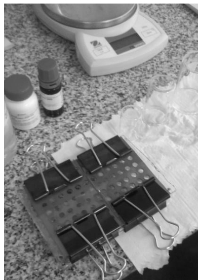
Figura 7. Fotografía que muestra el sistema utilizado para medir la actividad de la AEB una vez transferida al soporte de vidrio.
