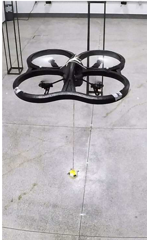
Figura 29 – Foto do quadrimotor utilizado com a carga suspensa e com os obstáculos ao fundo.
