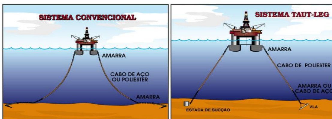
Figura 1.12 - Ancoragem em catenária e sistema TAUT-LEG [40]
