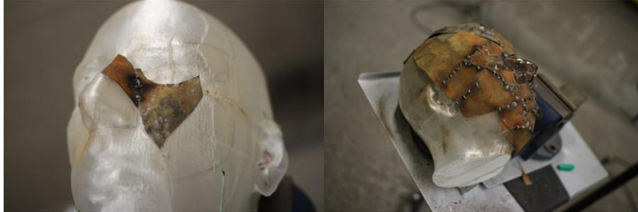
**Figure 20 - Plaques métalliques pliées et soudées.**
