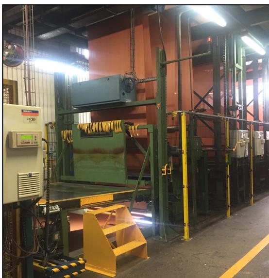
*Figura 2.5 – Máquina de Impregnar ZELL – Zona da tela já impregnada*
