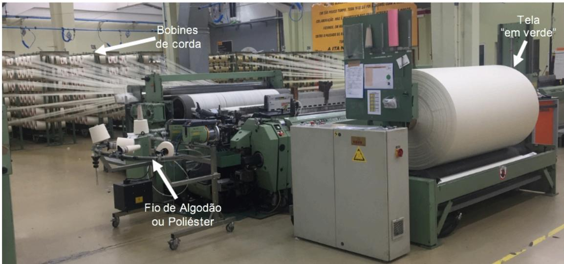
*Figura 2.3 – Seção de Tecelagem*
