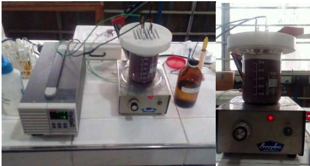
Figura 2. Sistema de electrocoagulación.
