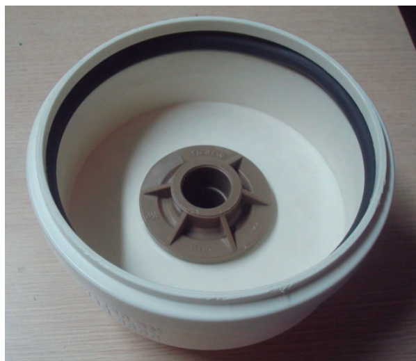
Figura 5 – Detalhe da inserção do flange no tampão
