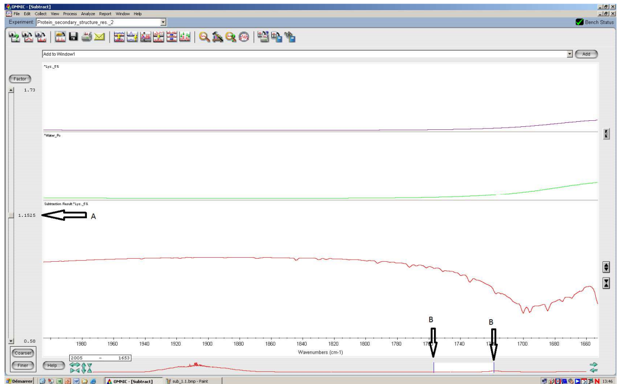
Figure 3 : Soustraction de l'eau du spectre du cytochrome C. A : molette du facteur de soustraction, B : intervalle de sélection.
