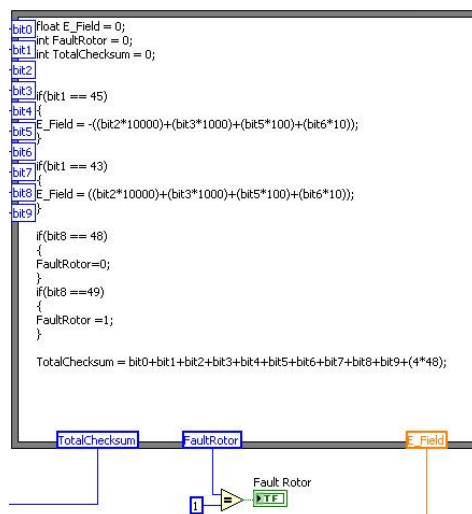
Figure 22 - Concaténation du champ et calcul du checksum
