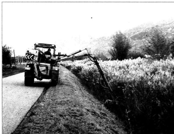
FIGURE 5 – Entretien de la station aval du canal des Polonais à l'aide d'une épareuse en 2006.
