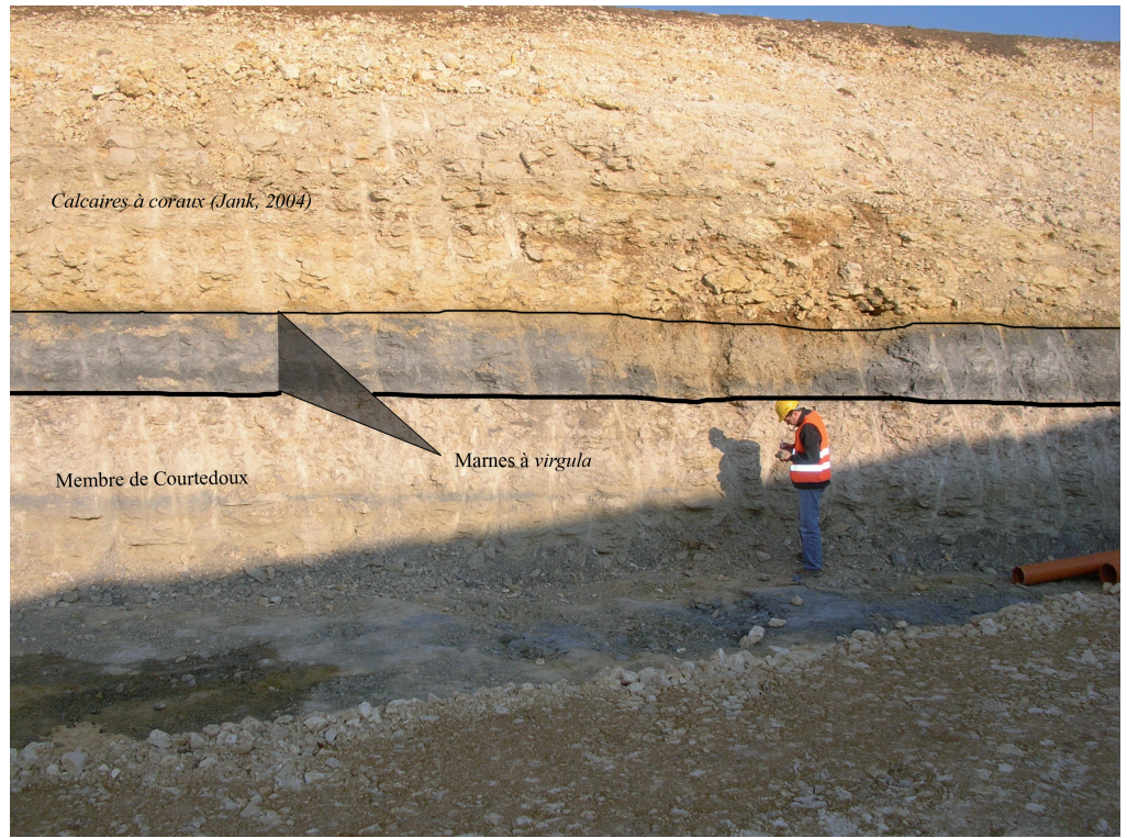
Fig.25 : Sommet du membre de Courtedoux sur le site de Courtedoux-Tchâfouè. Les Marnes à virgula sont très facilement reconnaissables par leur aspect gris/beige et argileux.
