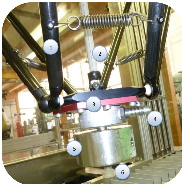
Figure 63 : Nacelle avec masse d'1 [kg]
