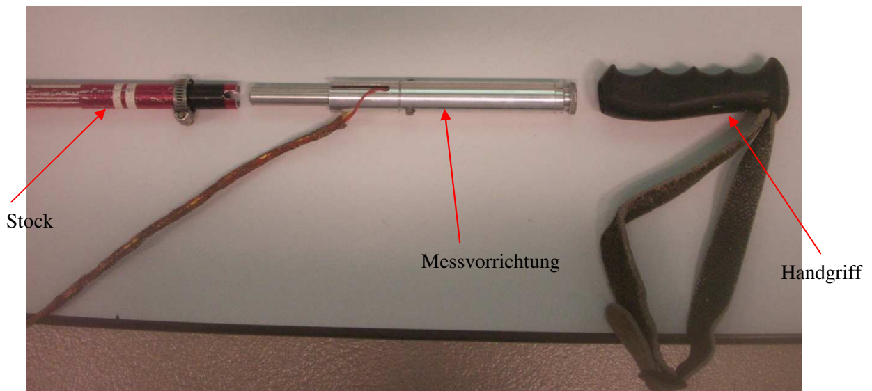
Abbildung 6-1: Kraftmessvorrichtung vor der Montage im Stock
