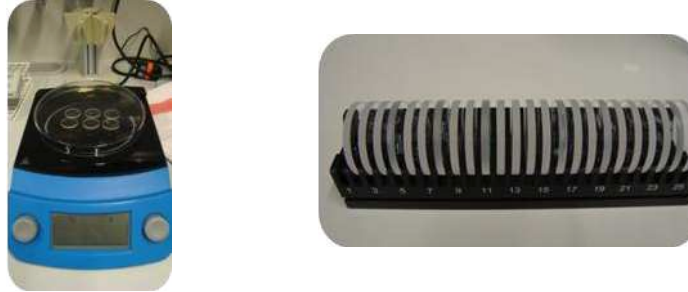
Abbildung 15: Bild eines Quartzprobenträgers und der Heizplatte
