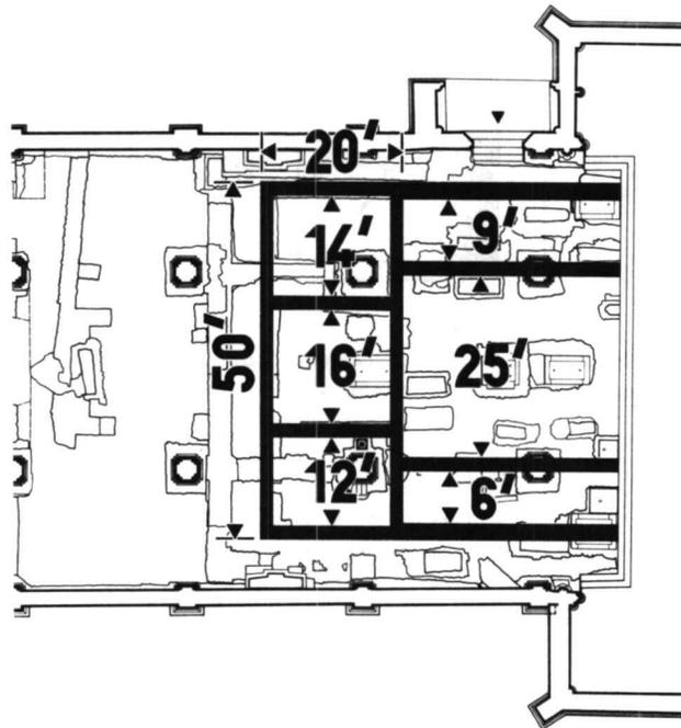
Abb. 3. — Anlage I: Grundriss mit den Abmessungen in Fussmassen (ein drusischer Fuss = 0,33 m; Massstab 1 : 400).
