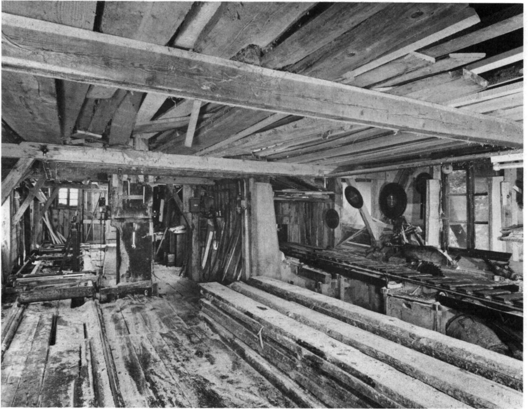
Pl. XXIX. — Intérieur de la scierie: la scie à demi-cadre et la scie circulaire, vues du nord. Photo Fibbi, 1984.
