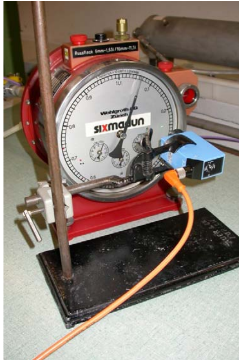
Abbildung 48: Trommelgaszähler L1-PVC Nr. 367738 mit Infrarot-Abtastung bei der Kalibrierung mit dem mobilen Messaufbau 136.70.
