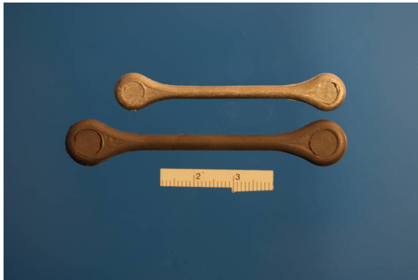
Figure 20 Comparaison de la longueur entre le corps vert et fritté
