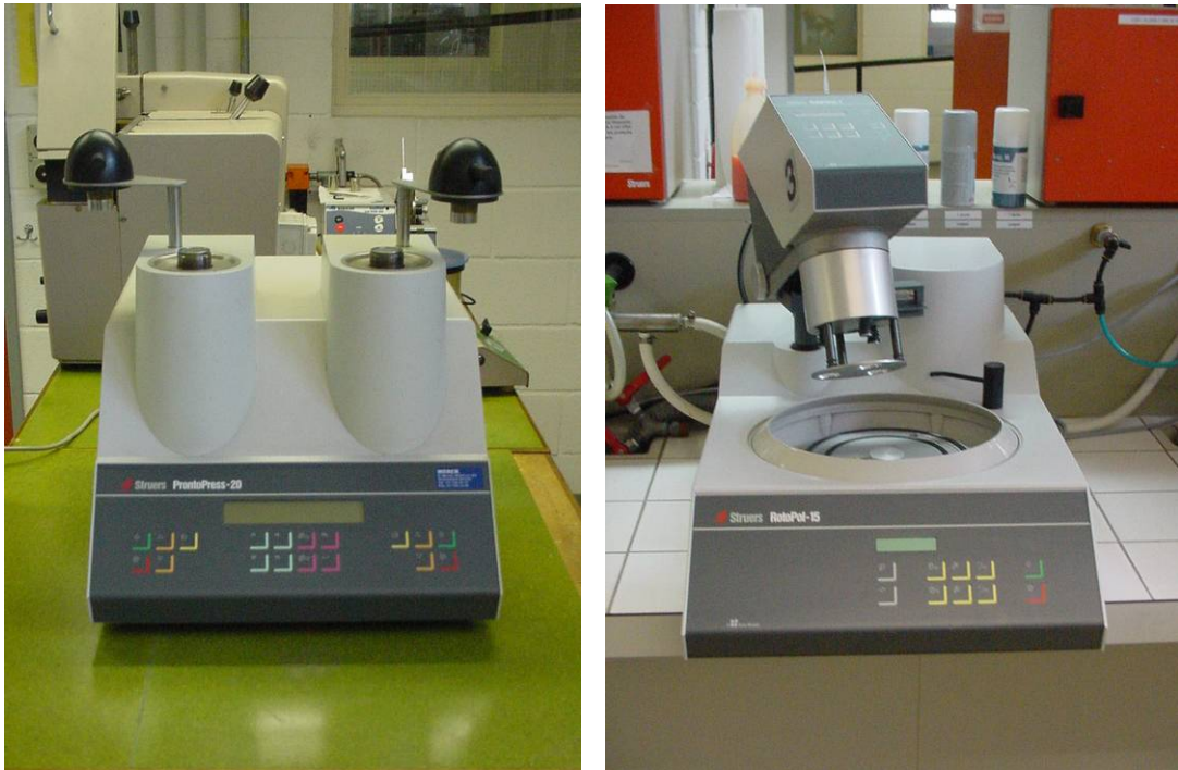
Figure 13. Unité d'enrobage (gauche) et unité de polissage (droite)
