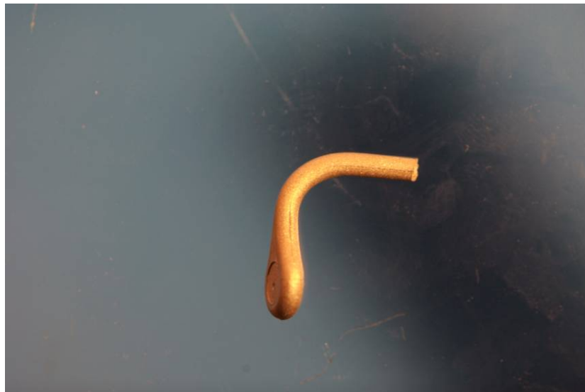
Figure 28. Eprouvette après un test de flexion
