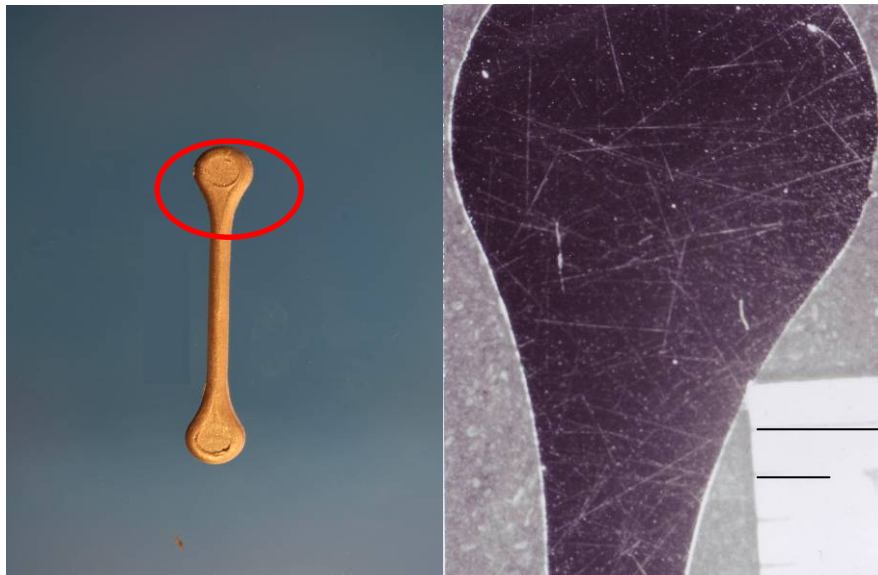
Figure 24. Tête de l'éprouvette réalisée à partir de Fs2
