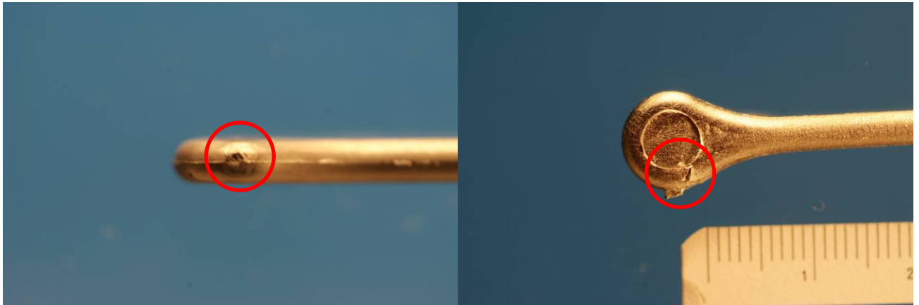
Figure 19 Défaut dans le corps fritté
