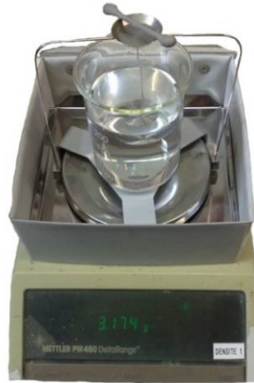
Figure 11. Balance de précision et le kit de mesure de densité
