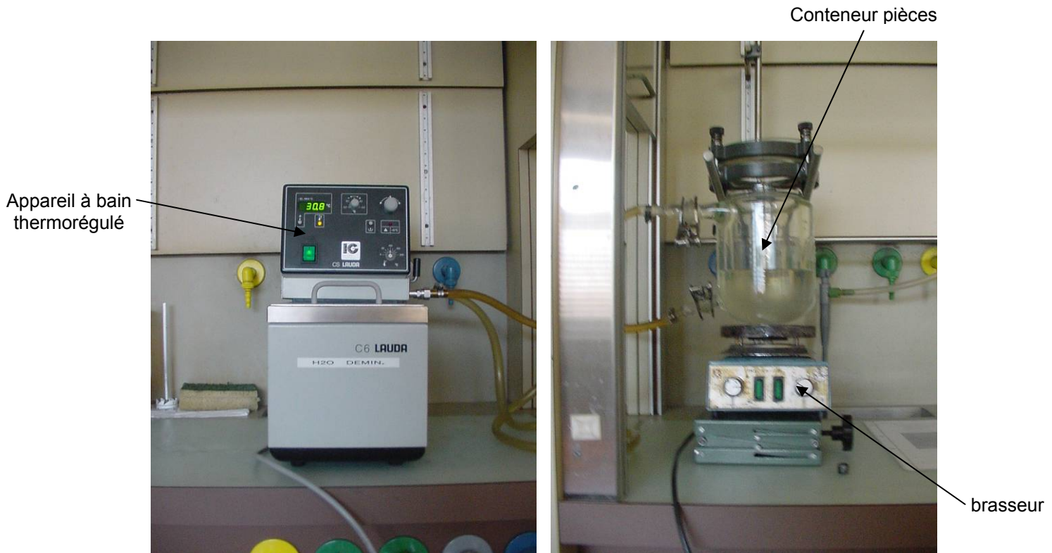
Figure 9. Equipement de déliantage à bain thermo régulé
