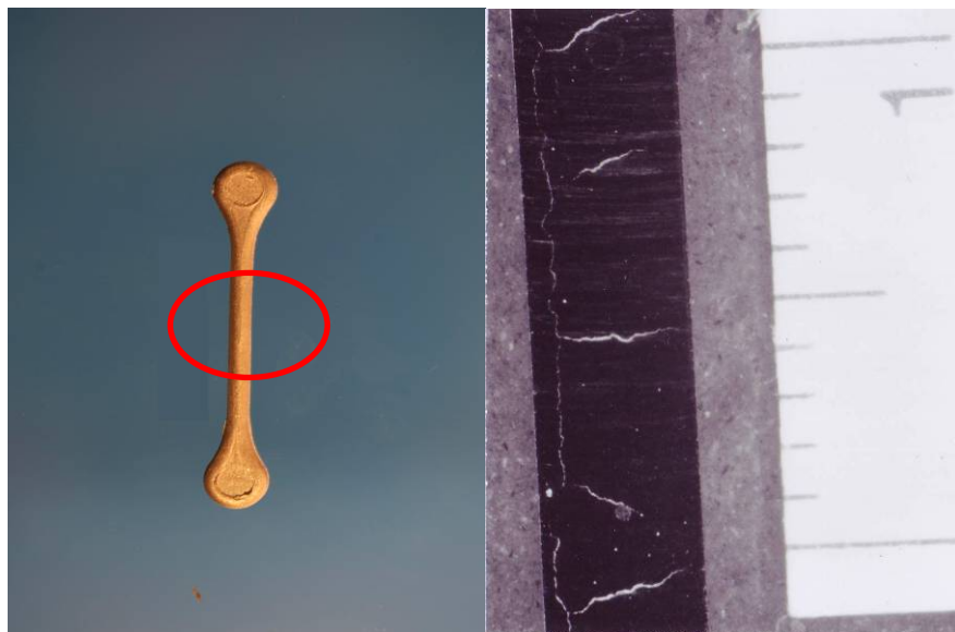
Figure 22. Corps de l'éprouvette réalisée à partir de Fs1
