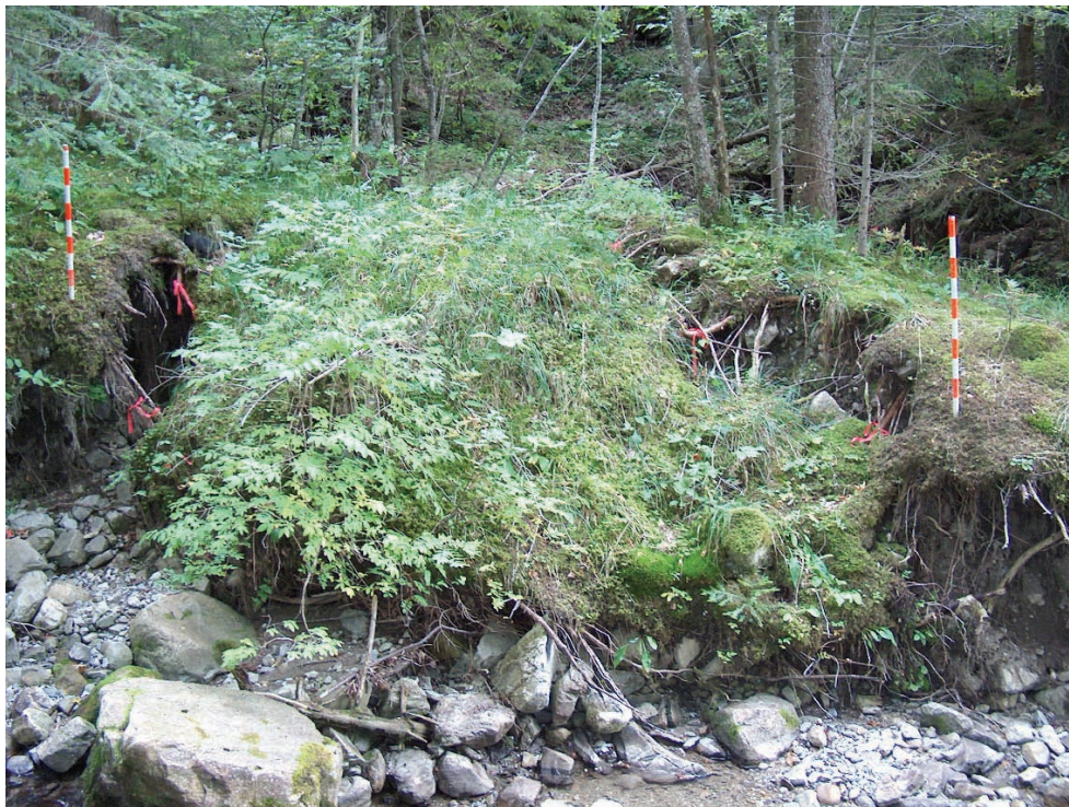
Abbildung 4: Zwei Uferrutschungen am Steinibach mit freigelegten Baumwurzeln. Die Unterspülung des Baches kann Rutschungen an den Einhängen (oben) oder Setzungen der Uferbereiche (unten) auslösen.
