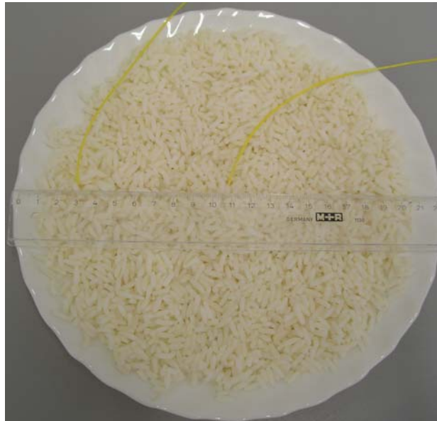
Figure 5 : Model d'incorporation des sondes dans une assiette avec une portion de riz aplatie
