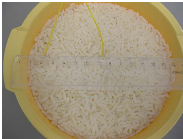
Figure 2 : Model d'incorporation des sondes dans le plat PYREX
