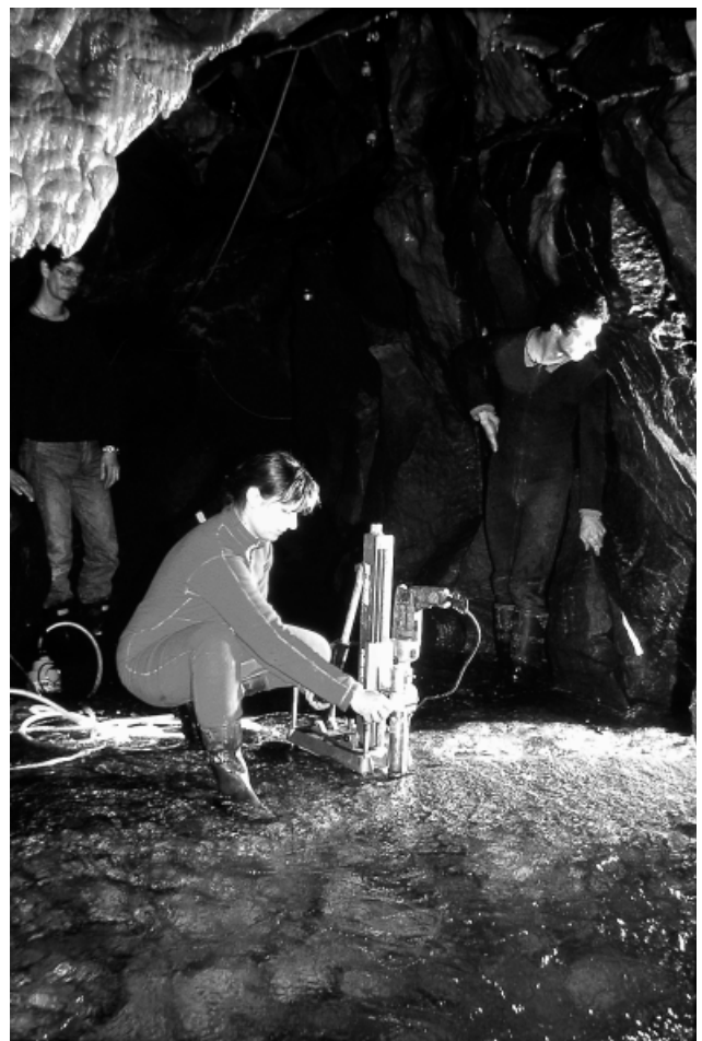
Fig. 6-12: Coring in the river... Kernbohrung im Fluss... Carottage dans la rivière...
