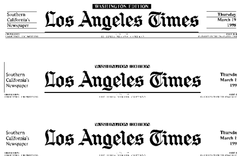
Figure 3.2: Filtrage des filets: deux opérations de filtrage sont nécessaires; sur la deuxième image, les deux filets verticaux, ainsi que le souligné du "Los Angeles Times" n'ont pas été éliminés car c'est un filet horizontal qui limite la composante connexe vers le bas.
