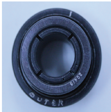
(d) A bearing with outer race fault
