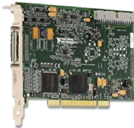
Figura 56: Targeta d'adquisició de dades PCI 6221 M de 68 pins de National Instruments.
