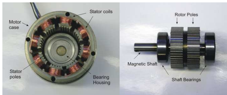
Figura 8: Estator i Rotor d'un motor pas a pas.
