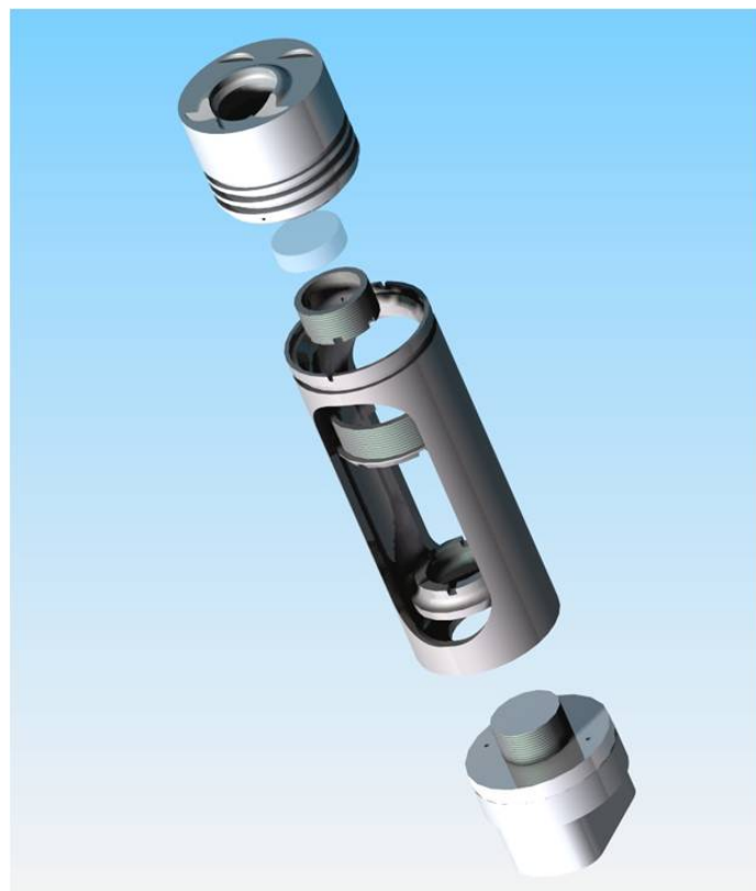
Figura 2. 14 Esploso dei componenti del pistone allungato, dall'alto verso il basso: Pistone Superiore, Finestra Bowl, Ghiera Bowl, Stelo allungato, Ghiera superiore, Ghiera inferiore, Pistone Inferiore
