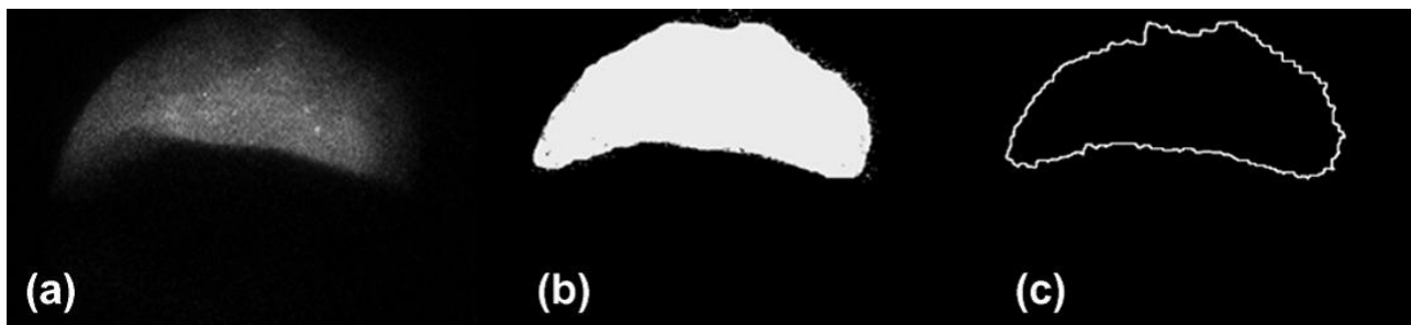
Figura 3. 3 Esempio della procedura per la determinazione del fronte di fiamma
