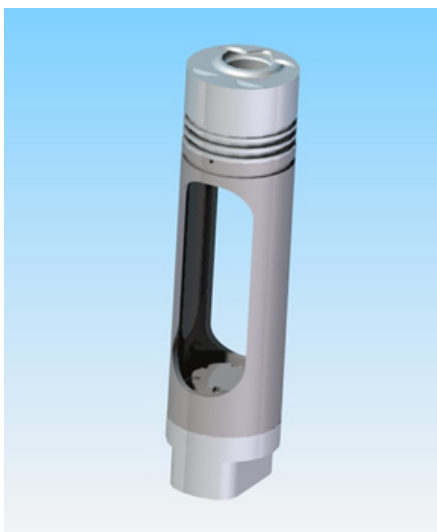
Figura 2. 13 Pistone allungato con asola per l'inserimento dello specchio a 45°.
