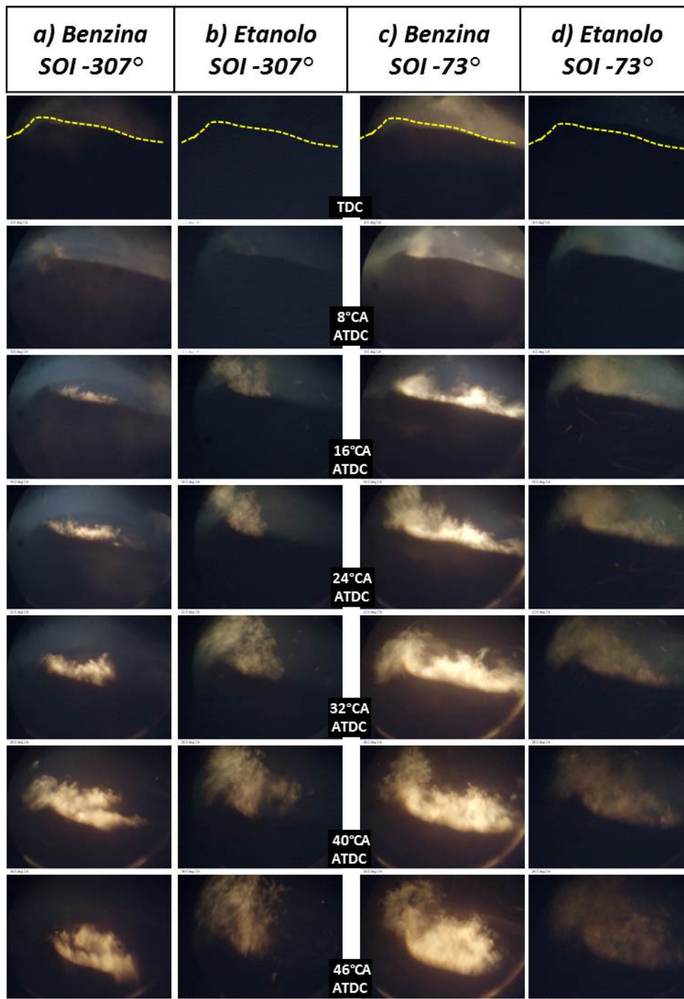
Figura 3. 24 Selezione di immagini della combustione acquisite dall'accesso ottico laterale con telecamera CCD, nella condizione a 1500 giri/min medio carico, per benzina ed etanolo al variare della strategia di iniezione.
