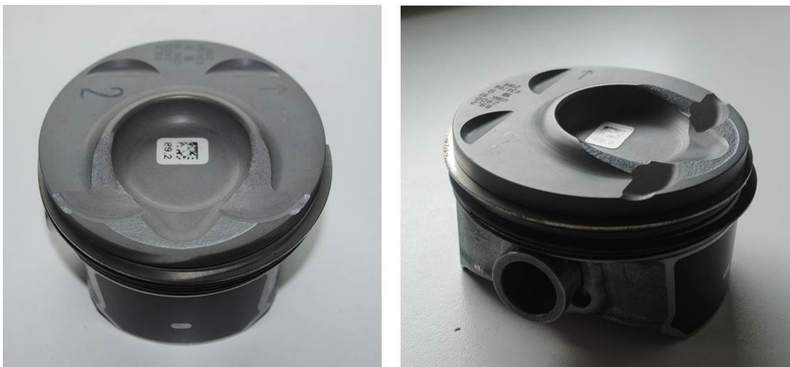
Figura 1. 4 Pistone del motore commerciale dal quale è stato derivato il motore otticamente accessibile
