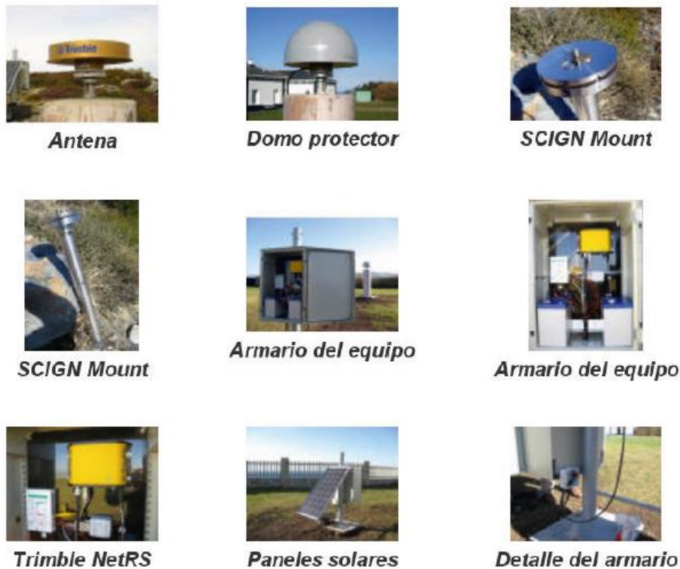
Figura 3.6: Instrumentación utilizada en la red CGPS topo-Iberia.
