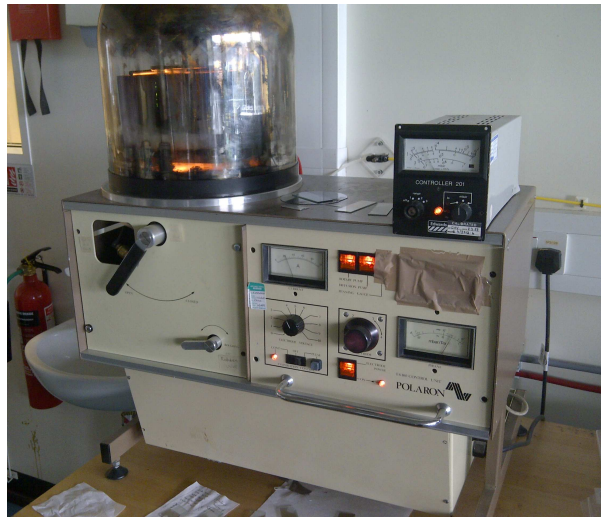
Fig. 5.2: Polaron Thermal Evaporator
