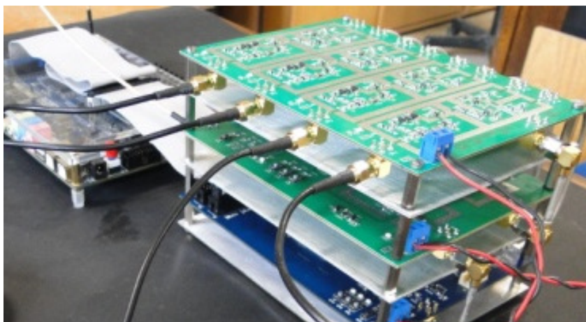
Figura 5: Receptor GNSS multiantena prototipo (izq) y arreglo de cuatro antenas (der).
