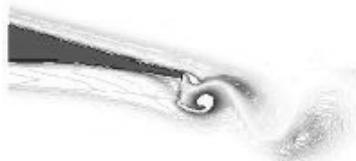
Figura 2. Esquema de las estructuras vorticosas contrarrotativas.
