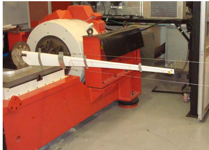
Figura 4: Pala en vibrador, con acelerómetro y tensores de carga en el CG.
