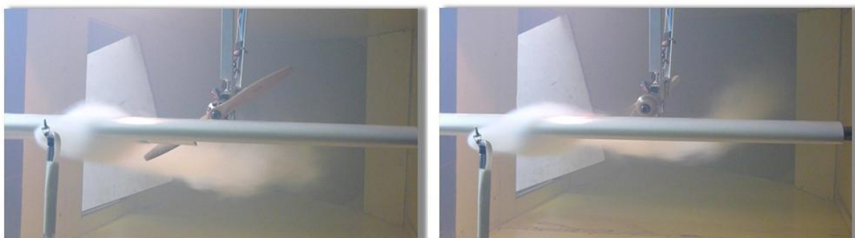
Figura 6. Vista de frente del ala con humo y flap a 20°. A la izquierda sin RPM y a la derecha con RPM.
