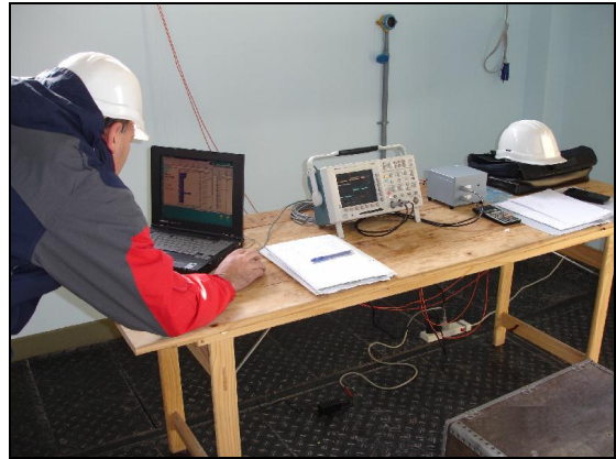
Foto N° 2.- Receptor de fibra óptica dual y osciloscopio de registro
