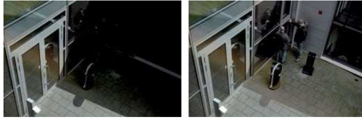
Fig. 4: (SINISTRA) ridotto range dinamico, (DESTRA) elevato range dinamico
