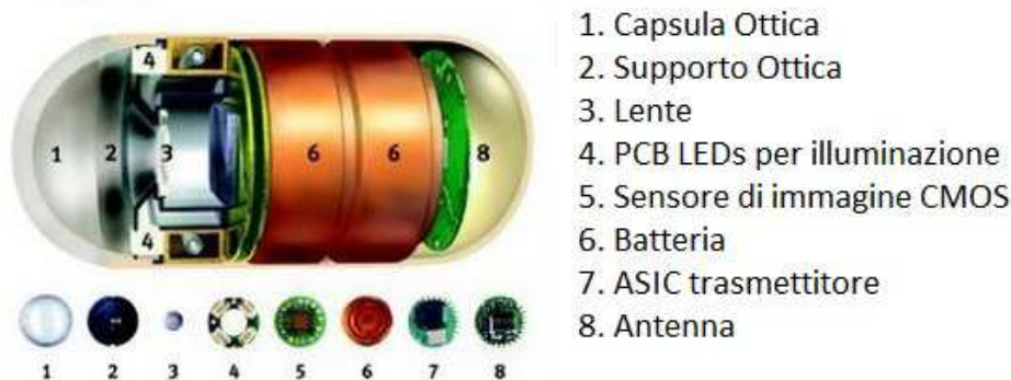
Fig. 9: Rappresentazione grafica dei moduli di PillCamSB2
