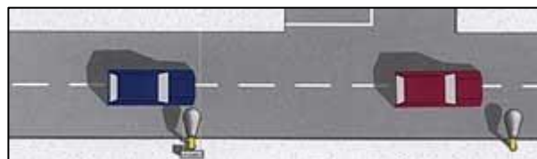
FIGURA 2-6 SCHEMA DI UTILIZZO DEI CONTATORI CON TECNOLOGIA LASER
