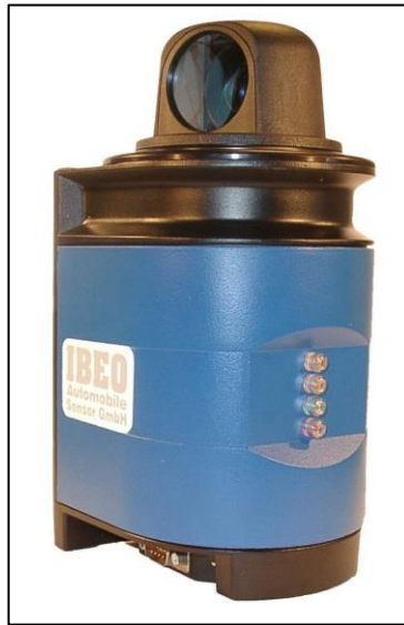
FIGURA 2-7 FOTOGRAFIA DI UN CONTATORE LASER IN GRADO DI CLASSIFICARE I VEICOLI
